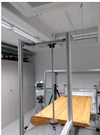
Abbildung 1: Aufgehängte Tischplatte mit Pendelschlaghammer zum Nachweis der Schwingungsfreiheit
