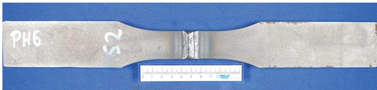
**Abbildung 62:** Probenform Stumpfstoß - Draufsicht
