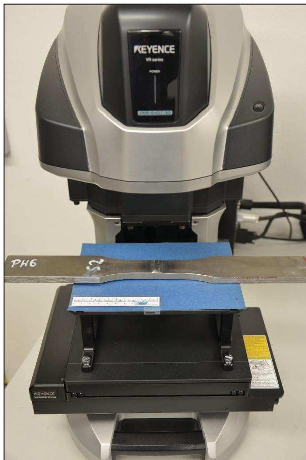
**Abbildung 39:** Probe im Prüfgerät - Stumpfstoß
