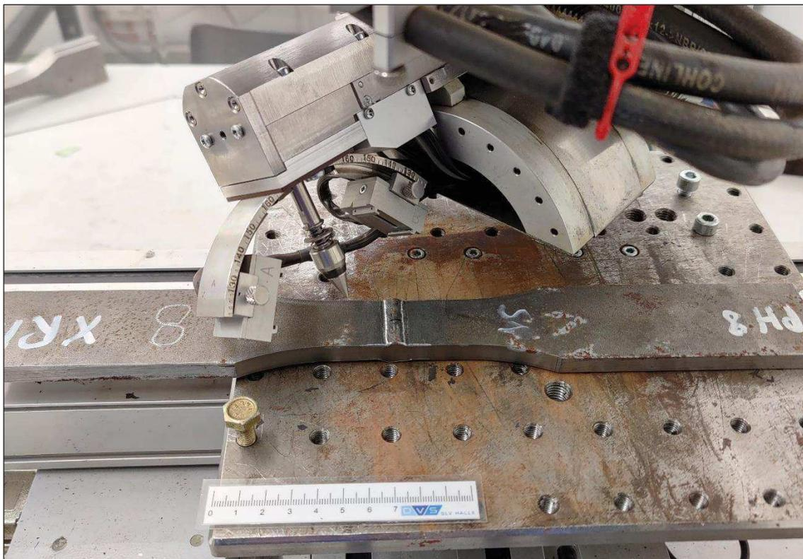
Abbildung 57: Eigenspannungsmessung an Stumpfstoßprobe (Versuchsaufbau)
