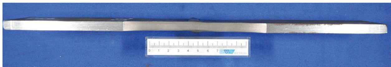
**Abbildung 63:** Probenform Stumpfstoß - Seitenansicht
