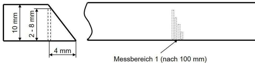
**Abbildung 46:** Probenvorbereitung zur Temperaturmessung bei induktiver Vorwärmung (Stumpfstoß)
