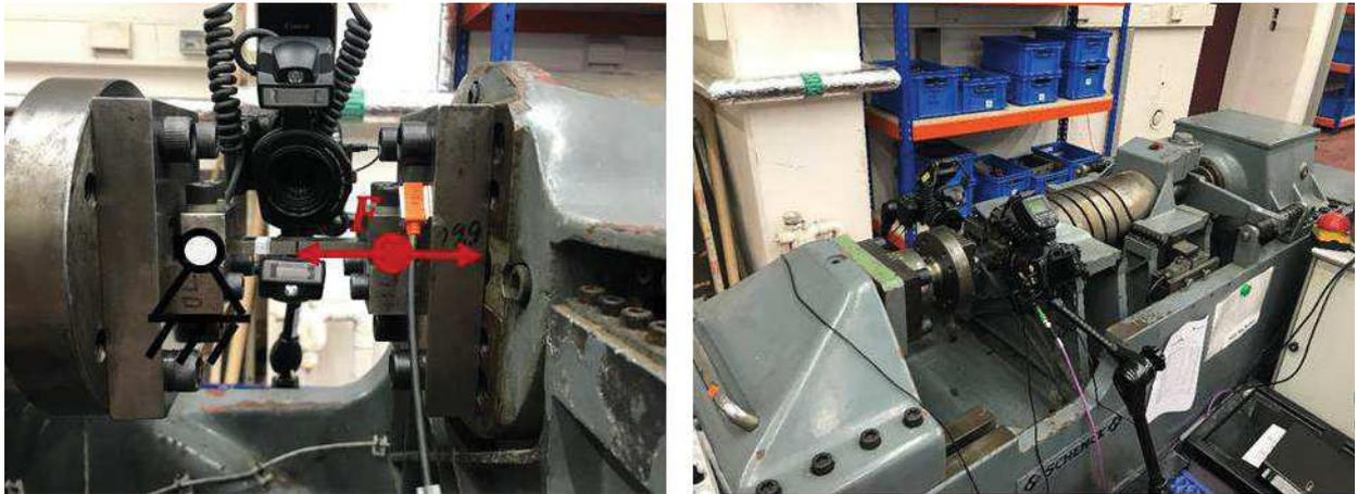
**Abbildung 75:** Versuchsaufbau und Kamerasystem zur Rissdetektion
