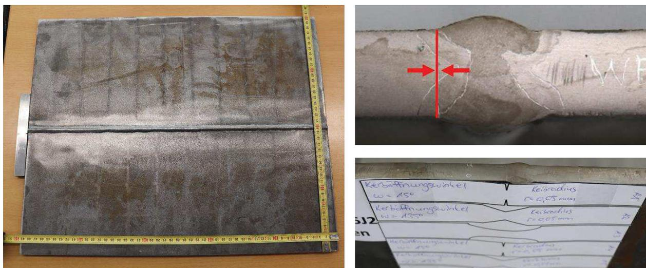
Abbildung 71: Entnahme der Proben aus den stumpfgeschweißten Platten
