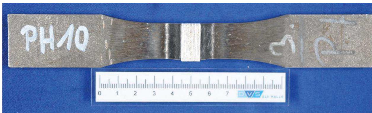
**Abbildung 64:** Probengeometrie der T-Stöße (Draufsicht)
