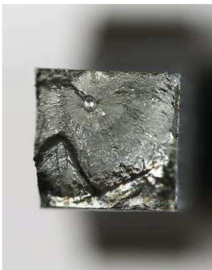
**Abbildung 88:** Innere Ungänge an einer ungekerbten Probe, des Werkstoffes S355MC
