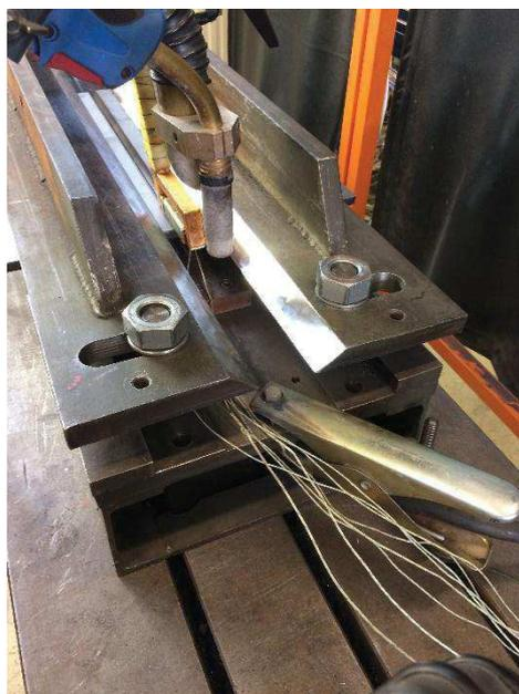
**Abbildung 47:** Vorversuche zur Parameterermittlung für das induktive Vorwärmen
