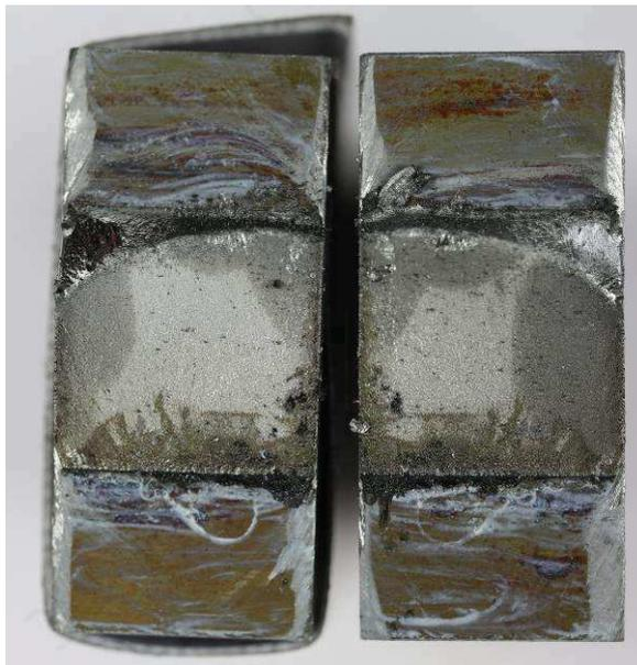
**Abbildung 87:** Typisches Bruchbild einer gekerbten Probe (IK) unter axialer Belastung,  $R = -1$ ,  $\phi = 15^\circ$ ,  $r = 0,05 \text{ mm}$ , Material: S960QL,  $K_t = 11,7$ ,  $N_B = 366.985$ ,  $\sigma_{N,a} = 93,75 \text{ MPa}$
