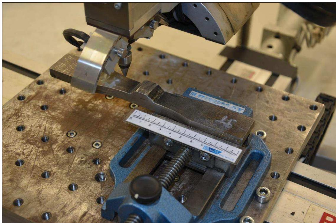
**Abbildung 60:** Eigenspannungsmessung an T-Stoßprobe (Versuchsaufbau)
